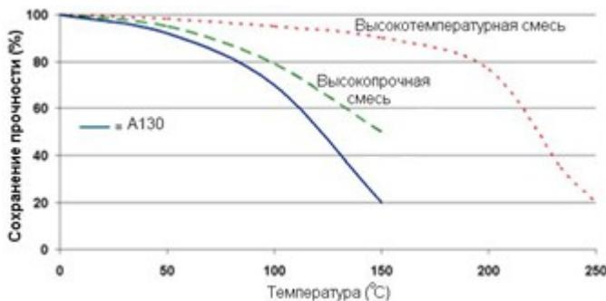
Уменьшение прочности обратно пропорционально охлаждению при условии, что место соединения не перегружено.
