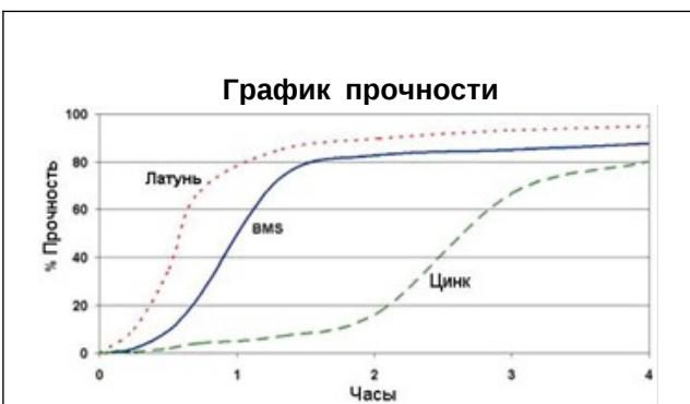
Клей, нанесенный на медь и ее сплавы, затвердевает быстрее, чем клей, контактирующий с окисленными или пассивными поверхностями, в том числе нержавеющей сталью. Набор прочности происходит быстрее при нагреве (до 80 °C) или в узком зазоре. Для ускорения полимеризации можно использовать активатор.
