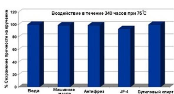
Состав не рекомендуется использовать в соединениях, которые будут контактировать с паром или с чистым кислородом. Следует избегать длительного контакта с сильными кислотами, щелочами и полярными растворителями.
