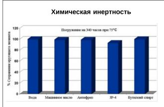
Состав не рекомендуется использовать в соединениях, которые будут контактировать с паром или с чистым кислородом. Следует избегать длительного контакта с сильными кислотами, щелочами и полярными растворителями.
