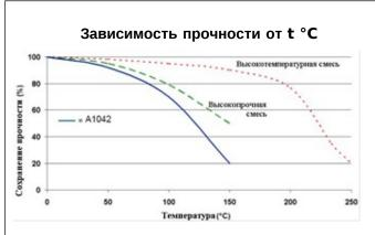
Уменьшение прочности обратно пропорционально охлаждению при условии, что место соединения не перегружено. Подвергать соединения высоким температурам можно только в течение коротких промежутков времени.
