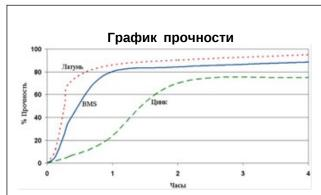
Клей, нанесенный на медь и ее сплавы, затвердевает быстрее, чем клей, контактирующий с окисленными или пассивными поверхностями, в том числе нержавеющей сталью. Набор прочности происходит быстрее при нагреве (до 80 °C) или в узком зазоре. Для ускорения полимеризации можно использовать активатор.
